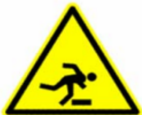
Pericolo di inciampo
